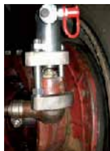
BEU 110 - с 50 мм подковой на на тяге самолета в Servisair, аэропорт Gatwick
