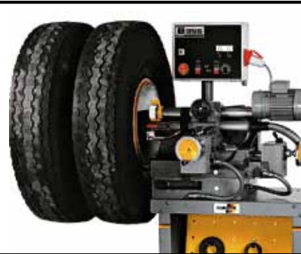
На стенде тормозной барабан легко проточить, не разбирая колесного узла
