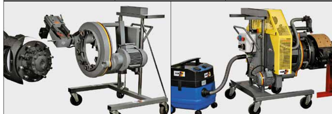
Проточка тормозных дисков на автомобиле
