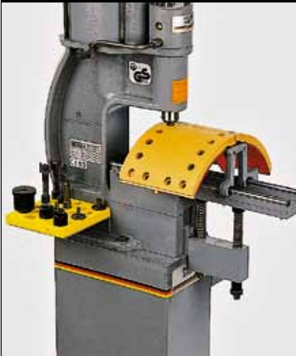
Инверсная и прямая клепка накладок тормозных колодок на опорном приспособлении гидропневматического станда N332
