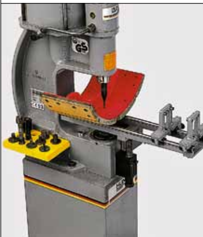
Инверсная и прямая клепка накладок тормозных колодок на опорном приспособлении гидропневматического станда N332
