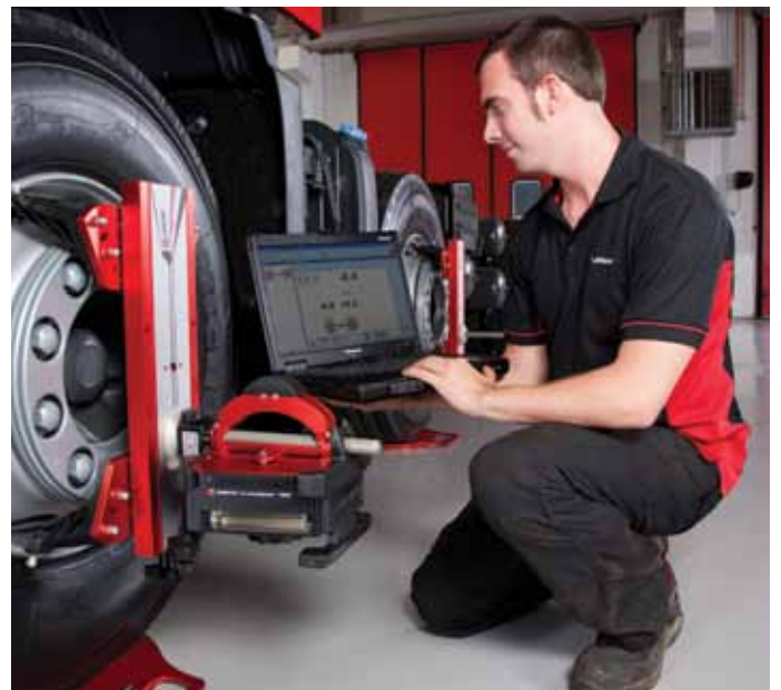
Переносной блок управления компании JOSAM
